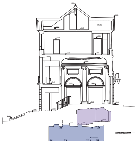
Emprise partielle de la galerie voûtée sous le niveau du sous-sol et présence d'eau Coupe Géomètre - Annotations Atelier Ergon - Photo DRIM
