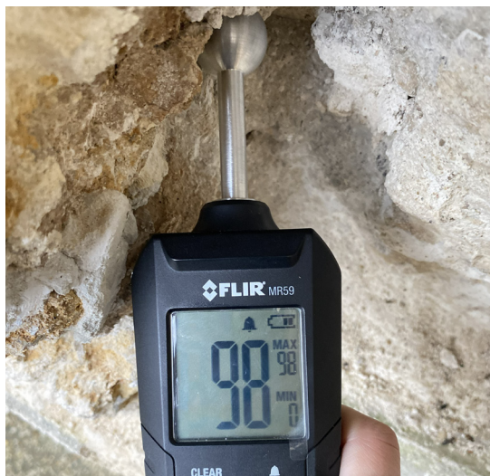
Relevé d'humidité au niveau de la maçonnerie sous une épaisse couche d'enduit Photo Atelier Ergon
