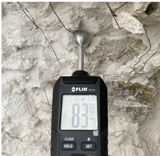
Relevé d'humidité à l'interface de deux enduits - 83% Photo Atelier Ergon
