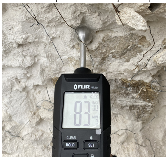
Relevé d'humidité au niveau de l'enduit Photo Atelier Ergon
