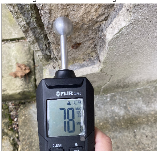
Relevé d'humidité au niveau du chaînage en pierre de taille Photo Atelier Ergon
