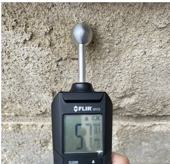
Relevé d'humidité au niveau de la surface de l'enduit Photo Atelier Ergon
