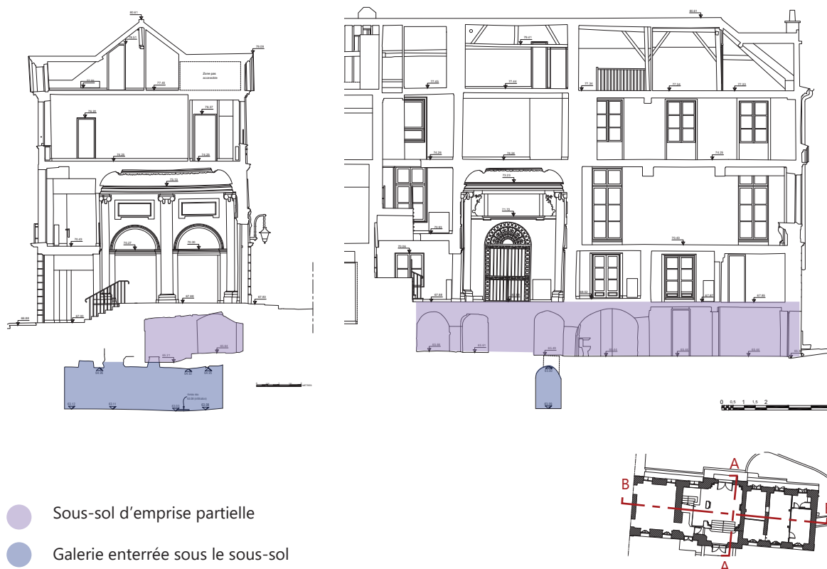
Emprise de la galerie voûtée Coupes géomètre - Annotations Atelier Ergon
