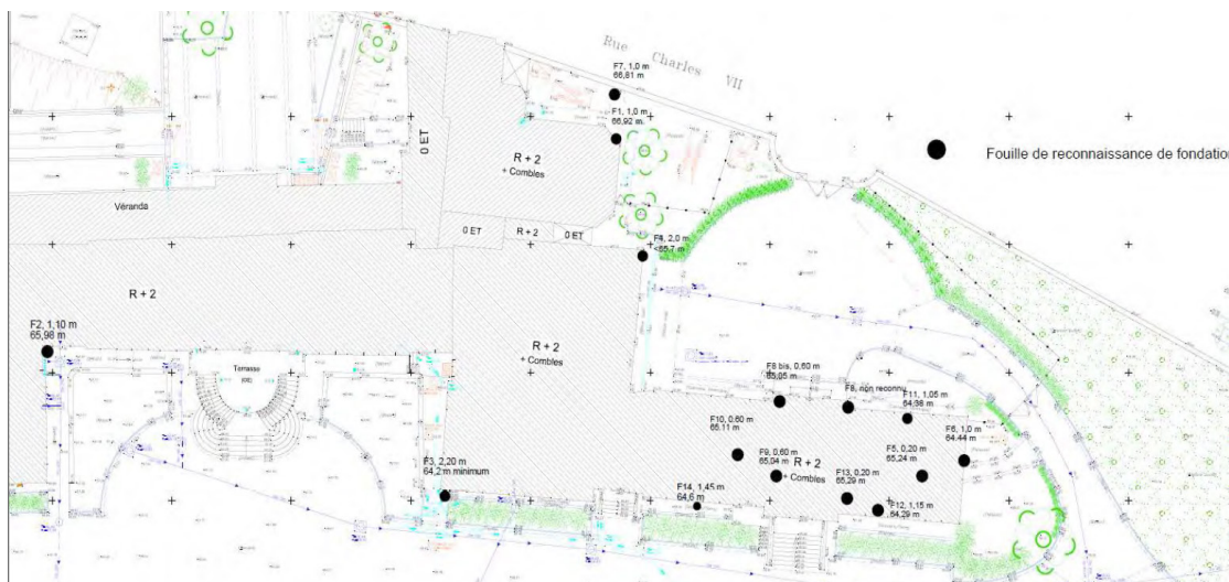
Ancrage des fondations - niveau RDC Extrait Rapport G5 - ECR 2023
