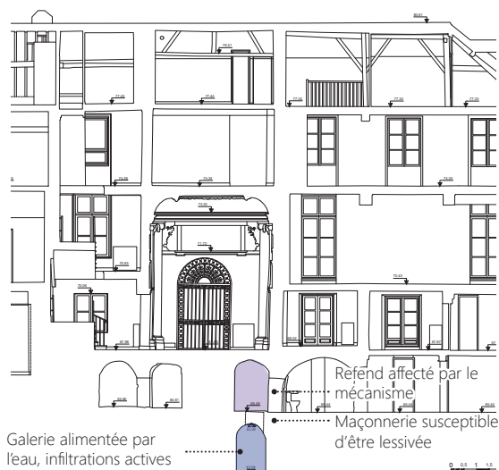
Contexte des infiltrations d'eau de la galerie et ouvrages avoisinants Coupe géomètre - Annotations Atelier Ergon
